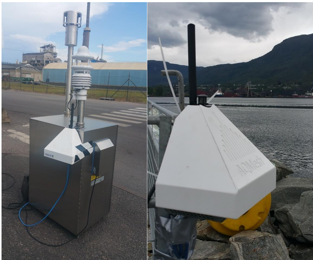
Figur 3.7 Til venstre er et referanseinstrument for svevestøv (Stor metallboks med inntaksrør og værstasjon) avbildet sammen med en mikrosensorenhet for PM og gasser. Mikrosensorenheten er også avbildet til høyre. Foto: Hege Indresand
