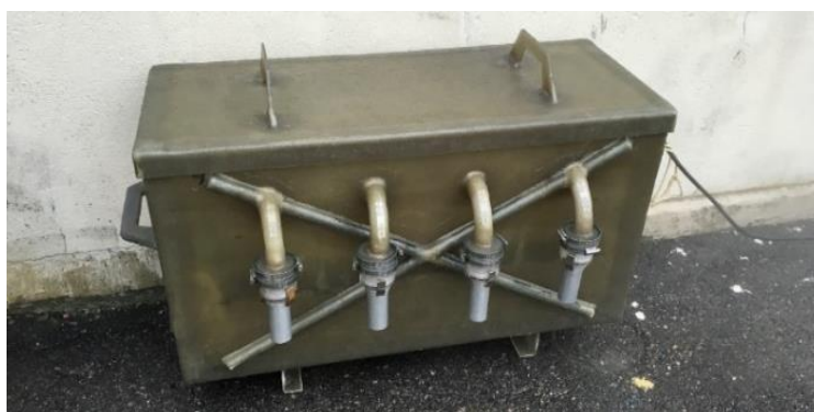
Figur 6.3 Nikkelverkets mobile målekasse for støvoppsamling på 3 filtre samtidig. Foto: Oluf Bøckman
