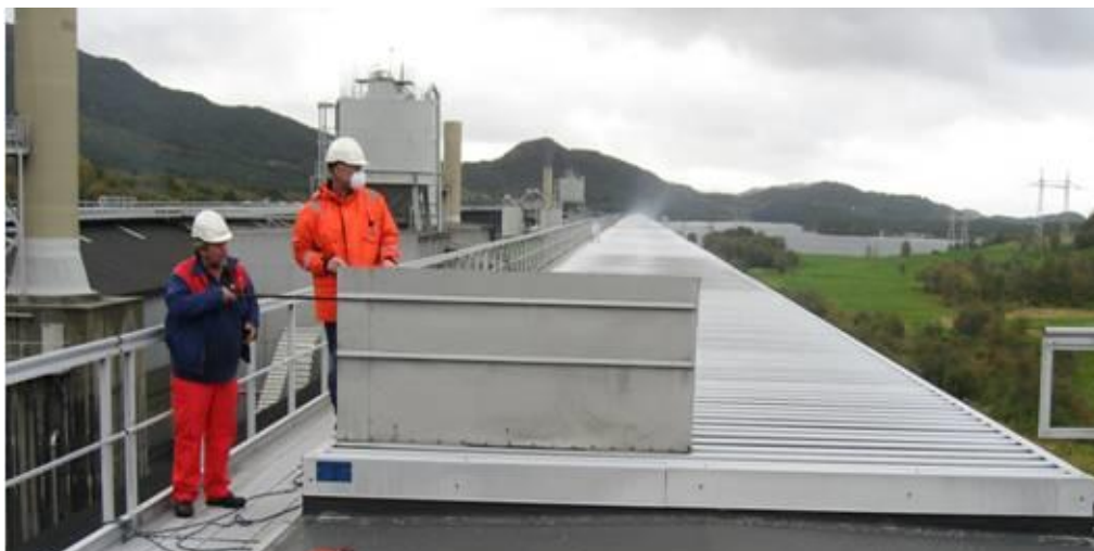
Figur 11.18 Målekasse for traversering med hastighetsmåler på oversiden av labyrintutløp. Foto: Håkon Skistad
