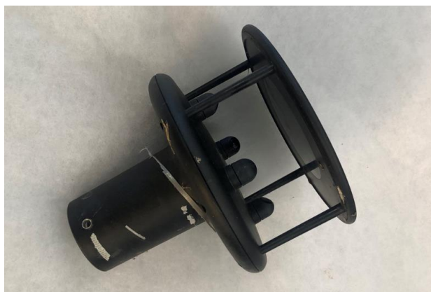
Figur 3.4 Sonde for ultralyd hastighetsmåler. Foto: Håkon Skistad.
