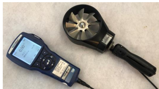
Figur 3.1 Vingehjulsanemometer med instrument som viser hastighet og temperatur. Foto: Håkon Skistad.
