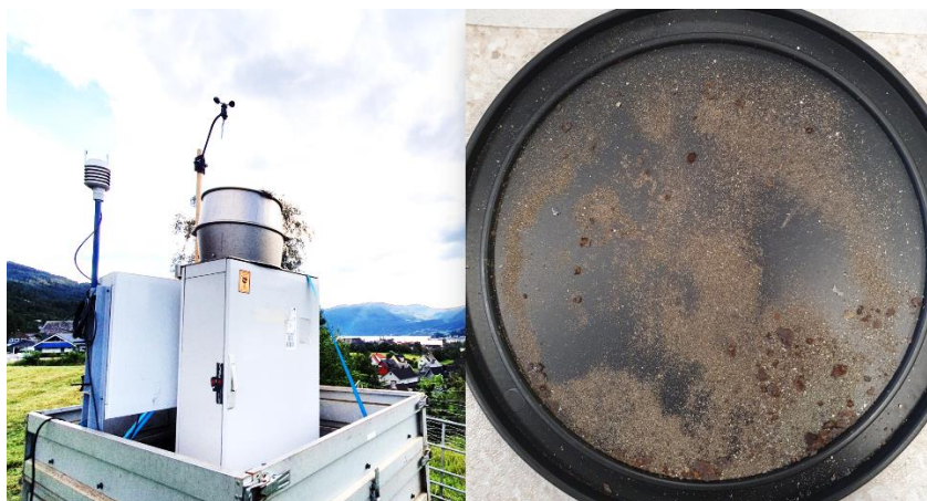
Figur 3.9 Eksempel på sensor for kontinuerlig timesmålinger av nedfallstøv i omgivelsene og en støvplate fra 24-timers oppsamling av støv i nærheten av en diffus kilde. Foto: Hege Indresand
