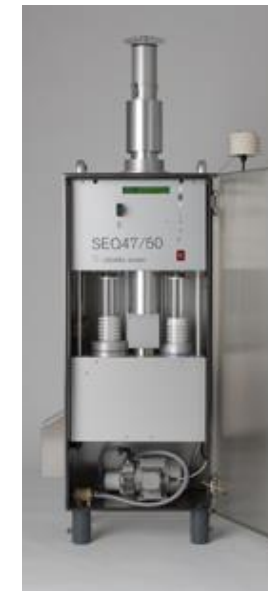
Leckel SEQ47/50 Sekvensiell lavvolum filter- prøvetaker
